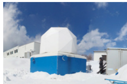
(図1) 野辺山に設置された1.85m電波望遠鏡。普段は電波透過膜を張ったドームを取り付けて観測している。右はドームを取り外した状態。
