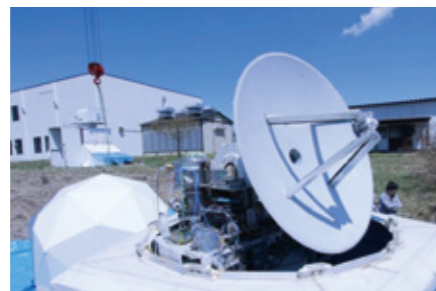
(図1) 野辺山に設置された1.85m電波望遠鏡。普段は電波透過膜を張ったドームを取り付けて観測している。右はドームを取り外した状態。
