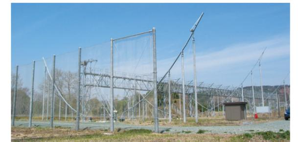
図2 名古屋大学宇宙環境研究所豊川分室（愛知県豊川市）にあるIPS観測用の大型電波望遠鏡
