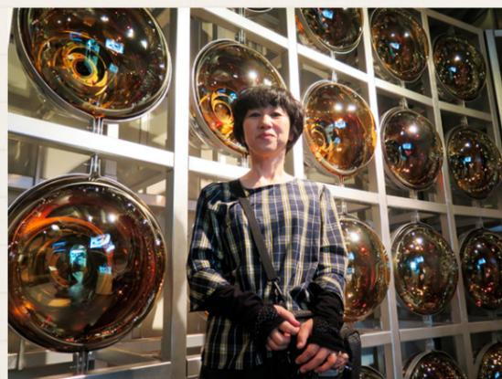
この写真で、壁にいっぱい並んでいるのが「スーパーカミオカンデ」で使われている光センサーのレプリカなんだ。「スーパーカミオカンデ」では、5万トン(学校のプール120杯ぐらい)を入れた水槽に、1万3000個の光センサーを敷き詰めているんだよ。
