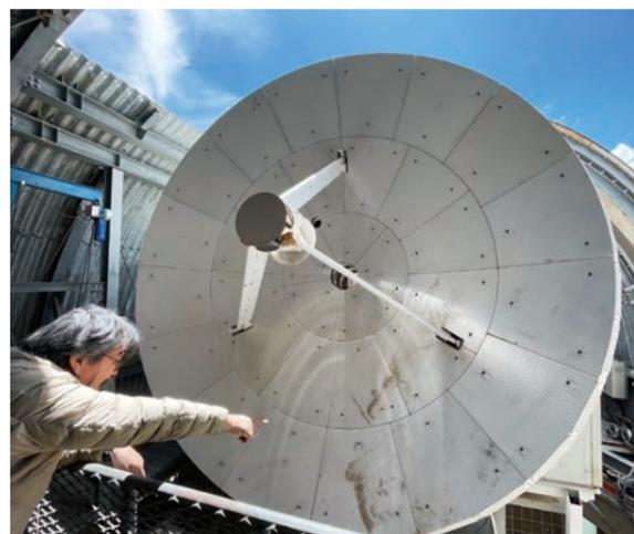
図1 砂がついて汚れてしまったNANTEN2の鏡面
