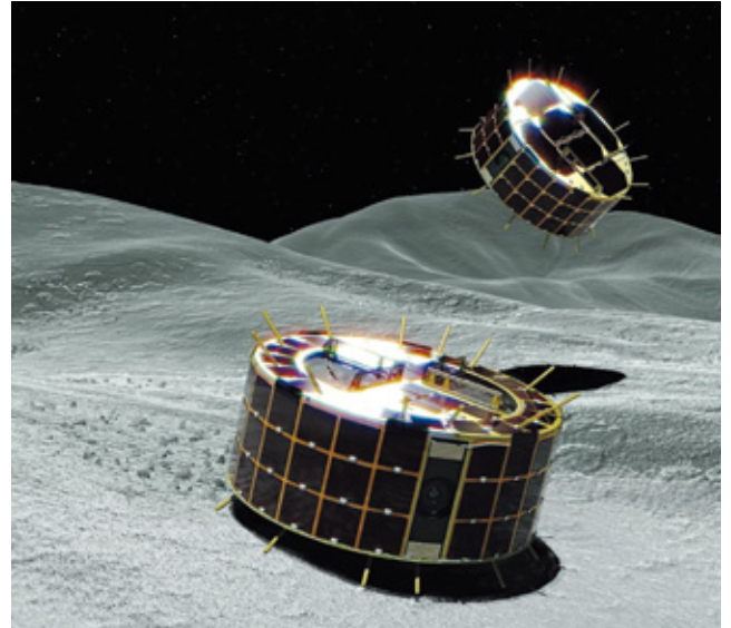
図7 リュウグウ表面の探査を行うMINERVA-IIのRover-1A(奥)およびRover-1B(手前)のイラスト。(画像提供:JAXA)
